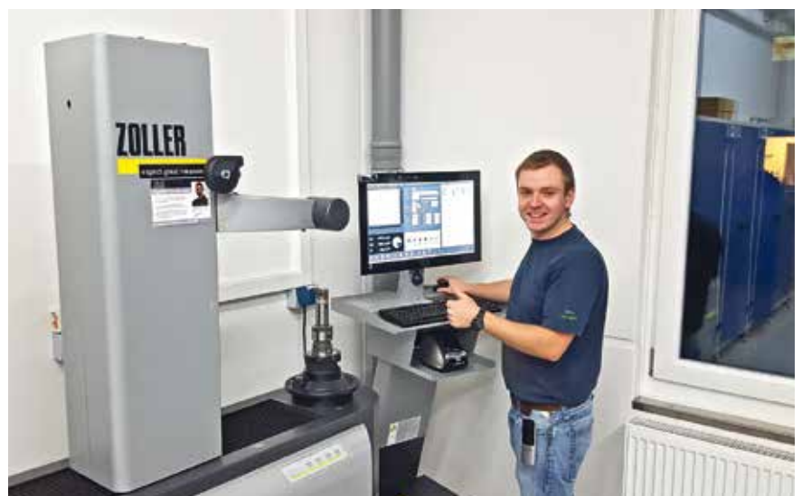
5 Messaufträge werden dem Voreinstellgerät digital bereitgestellt. Das umständliche Eintippen von Werkzeugdaten entfällt (© EVO)
