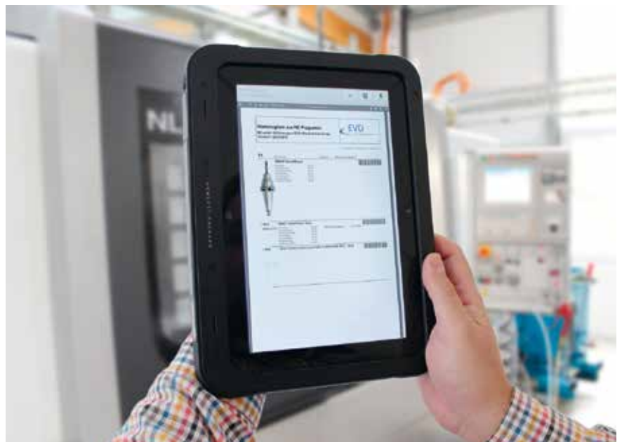
1 Die Toolmanagement-Lösung von EVO ermöglicht die Generierung einer aktuellen Werkzeugliste aus dem NC-Code. Für das Rüstdokument werden die Informationen aus der Werkzeugverwaltung genutzt. (© EVO)
