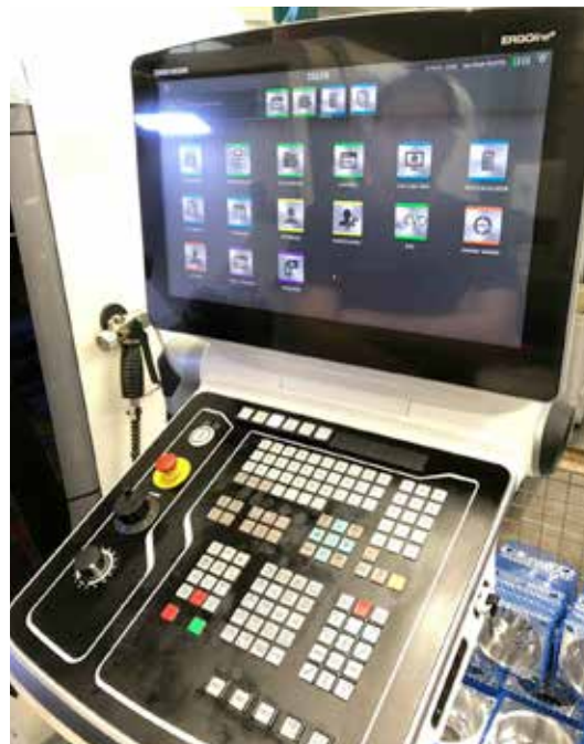
Apps auf der Maschinensteuerung: Auf modernen Steuerungen, wie zum Beispiel CELOS von DMG MORI, können Apps direkt integriert werden.
